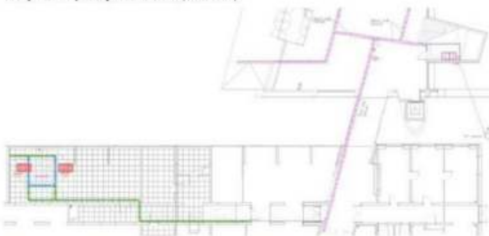
Slika 15. Nacrt prizemlja studentskog doma s dispozicijom trase TK sustava
